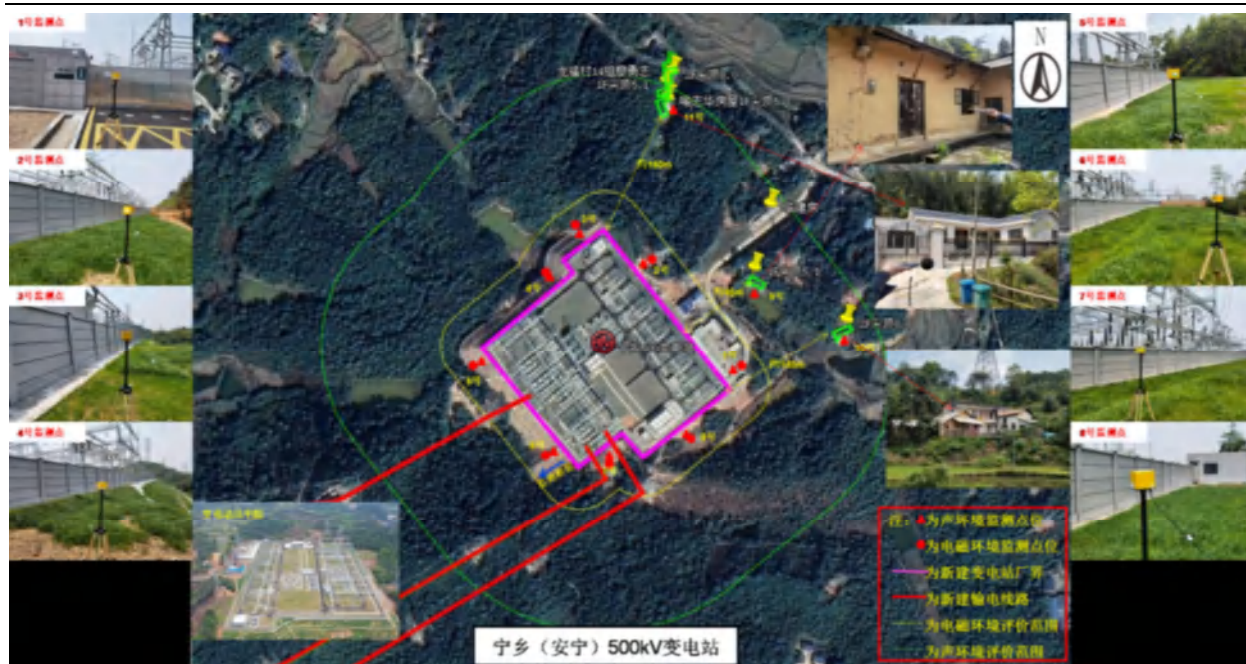
图 6.1-4 类比安宁 500kV 变电站电磁监测布点示意图
