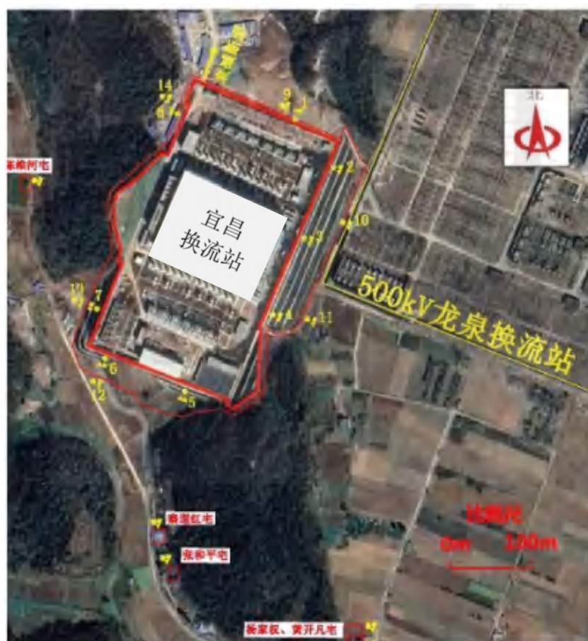
图 6.1-1 类比换流站（宜昌换流站）电磁监测布点示意图
