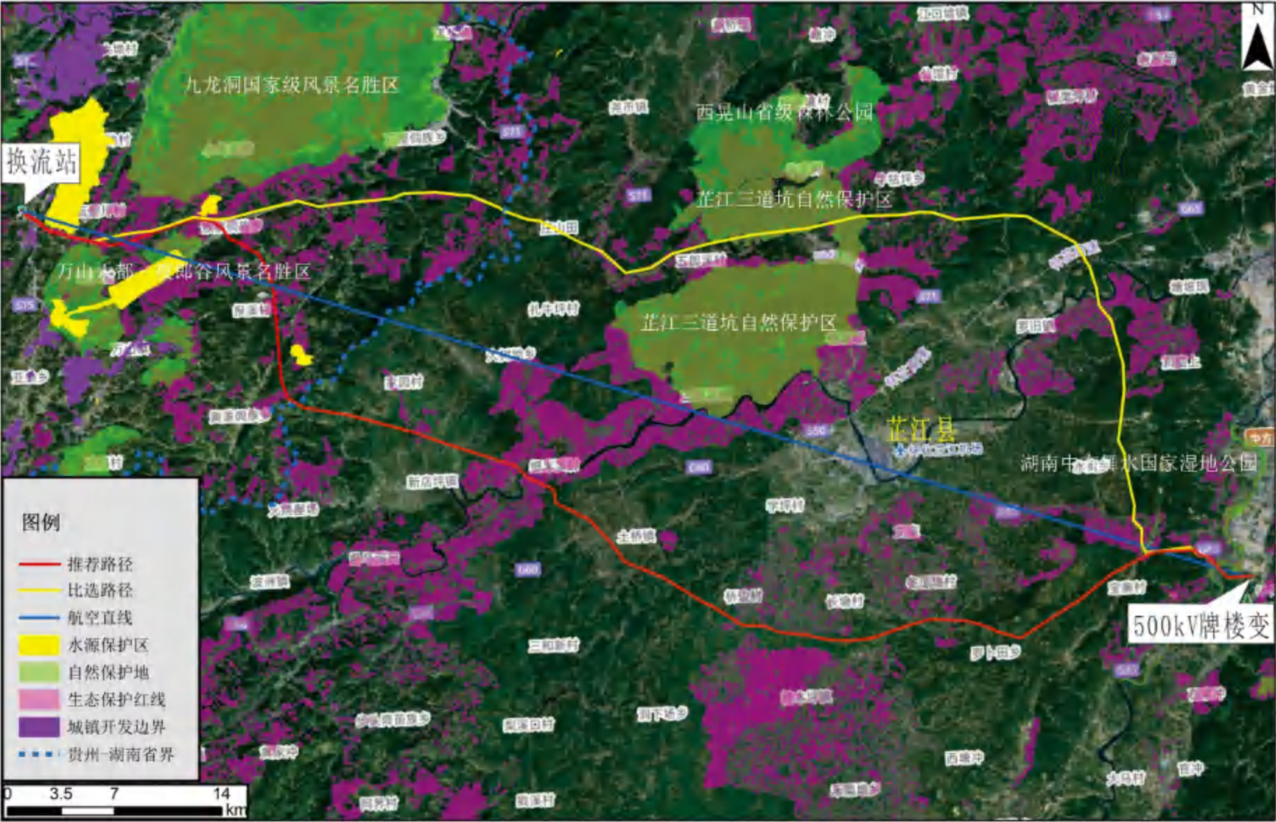
图 3.5-2 换流站～牌楼 500kV 线路路径比选方案示意图
